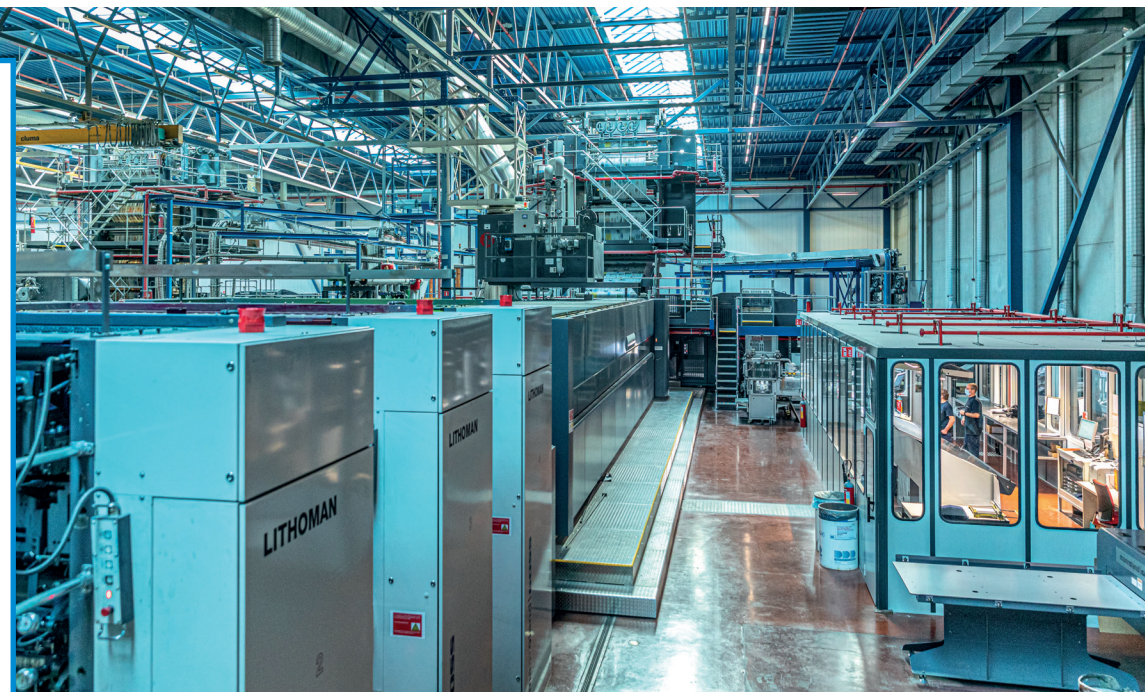
La nouvelle presse peut imprimer 50.000 cahiers de 64 ou même 72 pages par heure.
